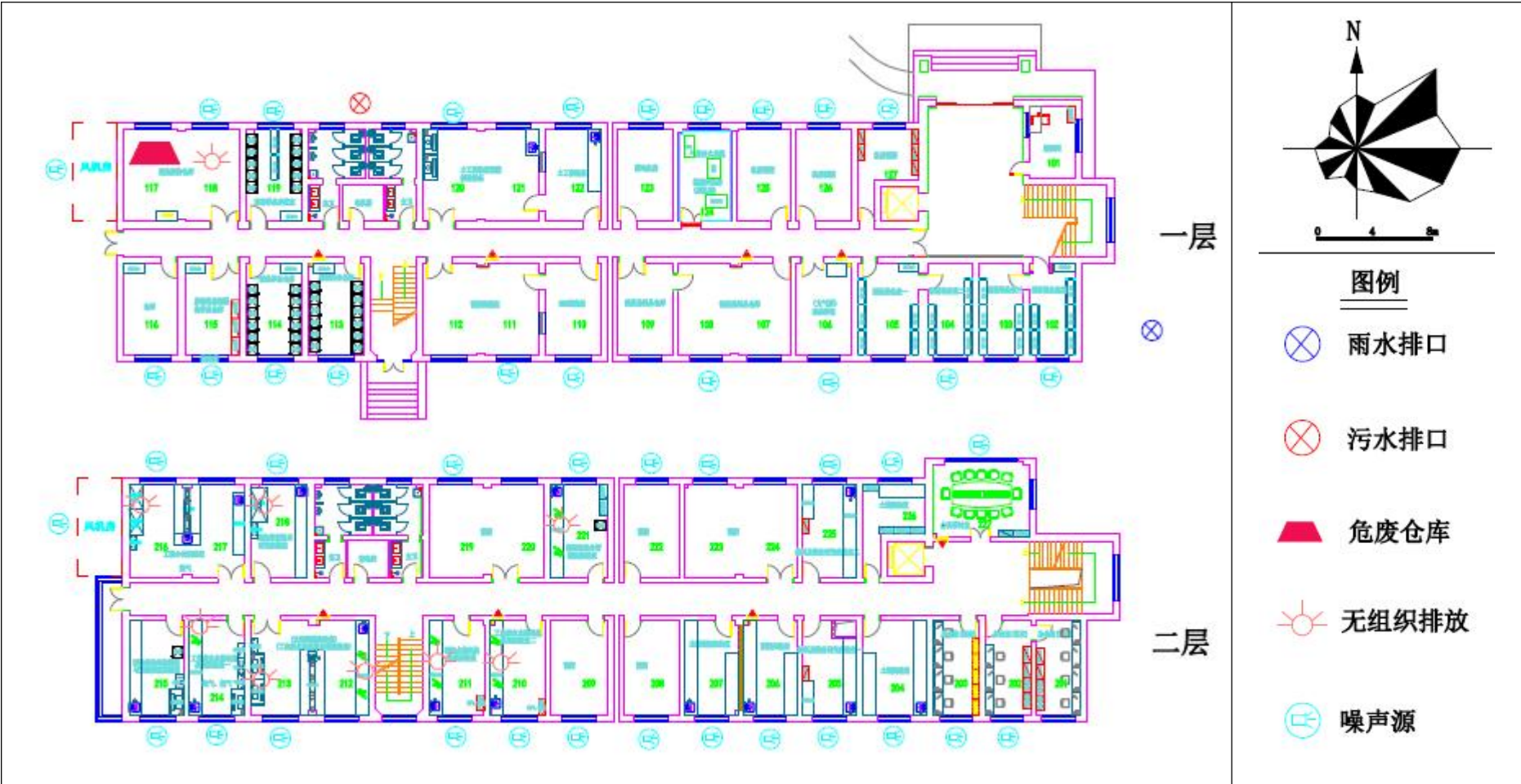
附图 2-1 项目平面布置图（一层、二层）
