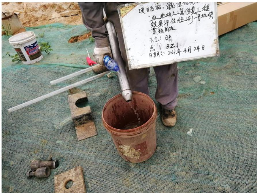
图 5-11 采样过程钻杆清洗
